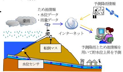
気象庁の予測降雨を自動でダウンロードして、リアルタイムにため池の 貯水位上昇及び下流側斜面の安定性を予測します。インターネットに接続 できる環境であれば、特別な設定を行う必要はなく解析が可能です。
