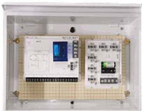
収納例:左 4ゲージ歪計1台(NetLG-401) 右 6ポートハブ(NetHB-1)
