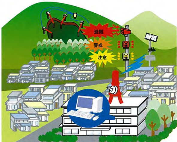
NetLG-501を使った遠隔観測例
